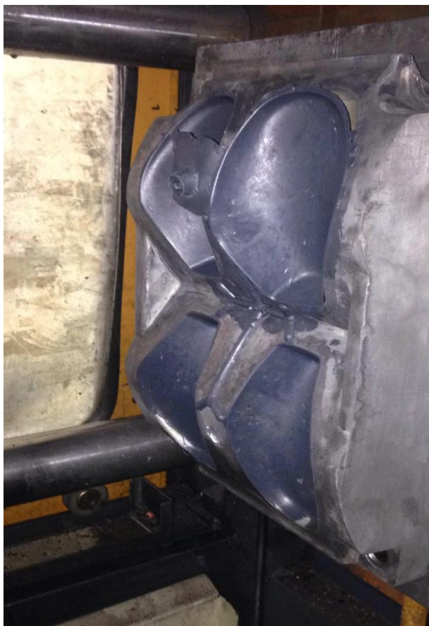
Figura 2. Armação após injeção
